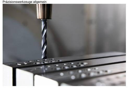
Die Bohrer mit der neuen Beschichtung bieten sehr hohe Schnittgeschwindigkeiten und lange Standzeit (Bild: Walter).
