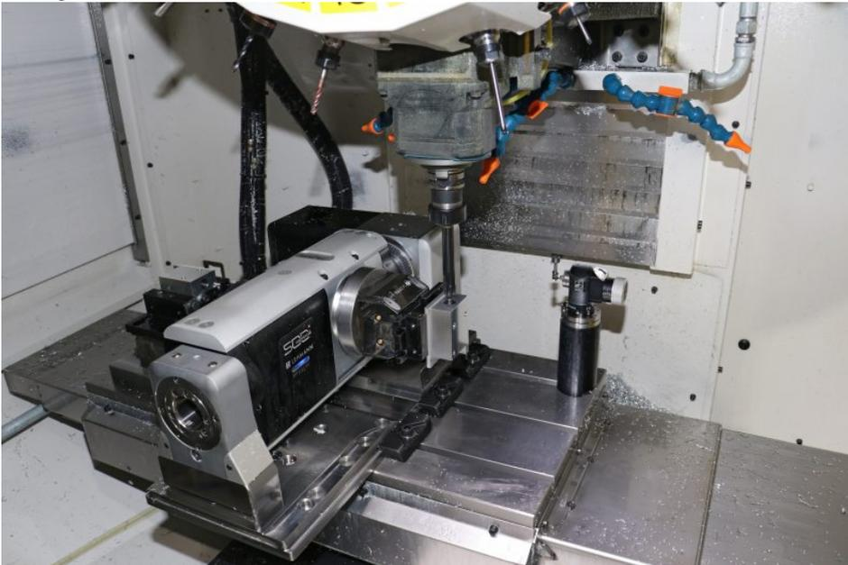
Der CNC-Drehtisch sorgt für flexible Mehrseitenbearbeitung und erlaubt sogar, 5-achsig simultan zu fräsen (Bild: pL Lehmann).
