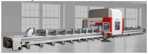
Die CNC-Maschine zur Bearbeitung von Aluminiumprofilen bietet eine Bearbeitungslänge von bis zu 20 m (Bild: Auratronic).
