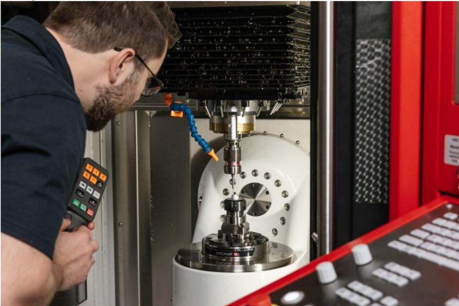
Das Mikro-CNC-Bearbeitungszentrum bietet eine sehr hohe Fertigungsgenauigkeit und arbeitet dank schneller Linearmotoren die Aufträge zügig ab (Bild: NH Micro/Kern).
