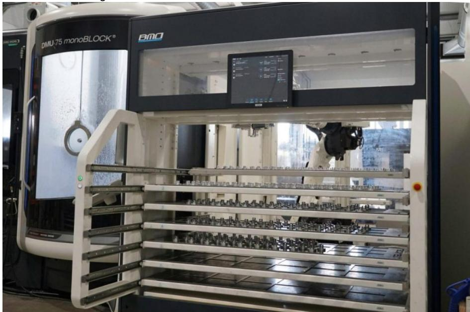
Die Roboterzelle trägt dazu bei, dass die Anzahl an Spindelstunden um einen Faktor 5 bis 6 höher ist als ohne (Bild: BMO).
