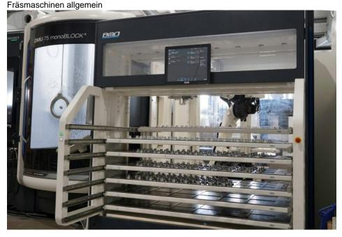
Die Roboterzelle trägt dazu bei, dass die Anzahl an Spindelstunden um einen Faktor 5 bis 6 höher ist als ohne (Bild: BMO).
