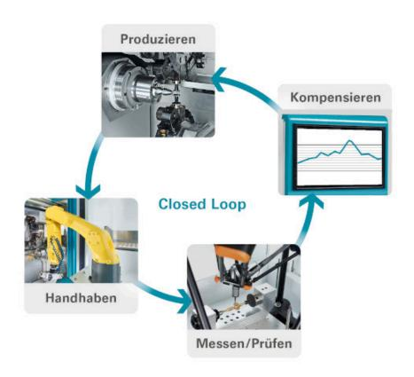
Die Automatisierung mit prozessbegleitender Messtechnik ist ein geschlossener Regelkreis mit vier Elementen (Bild: Index).
