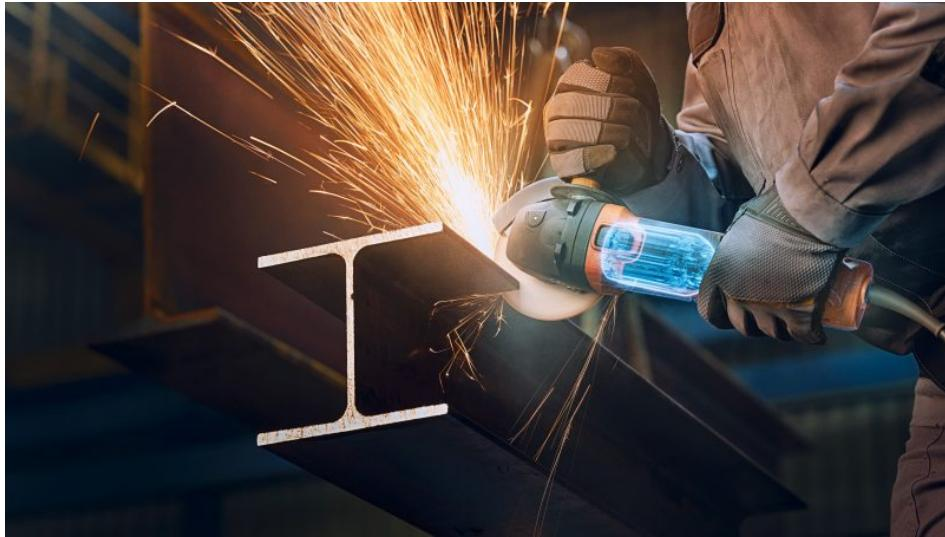
Der geschlossene bürstenlose Motor des kompakten Winkelschleifers und die geschützte Elektronik erhöhen die Lebensdauer (Bild: Fein).
