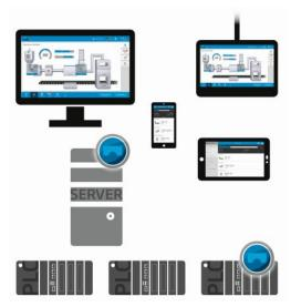
Die SPS kann direkt an Endgeräte angebunden werden oder die Kommunikation erfolgt über einen zentralen HMI-Server (Bild: Inosoft).
