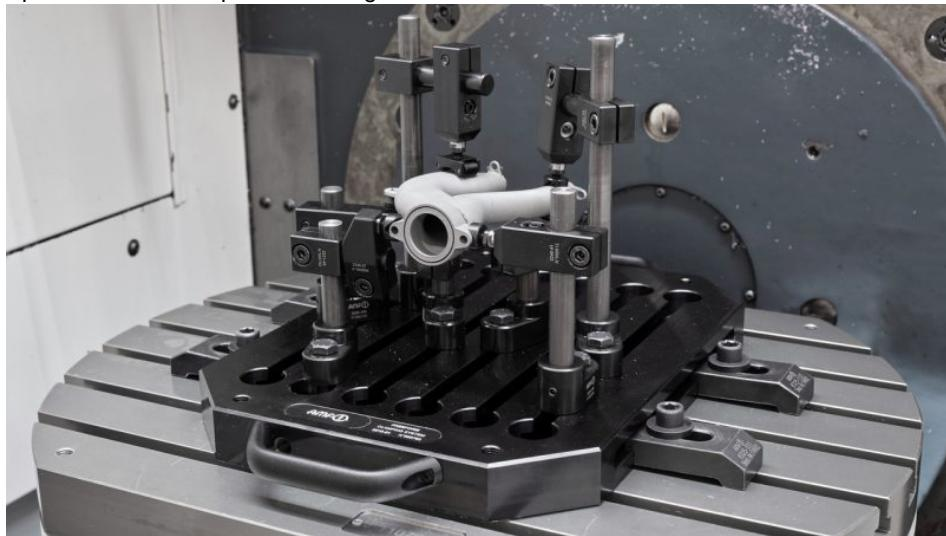
Mit dem modularen Spannsystem lassen sich komplexe Freiformbauteile flexibel und prozesssicher spannen (Bild: AMF).
