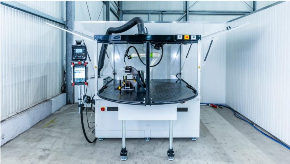
Der Schweißvorgang findet bei der Cobot-Schweißzelle in einer geschlossenen Einhausung statt (Bild: EWM).
