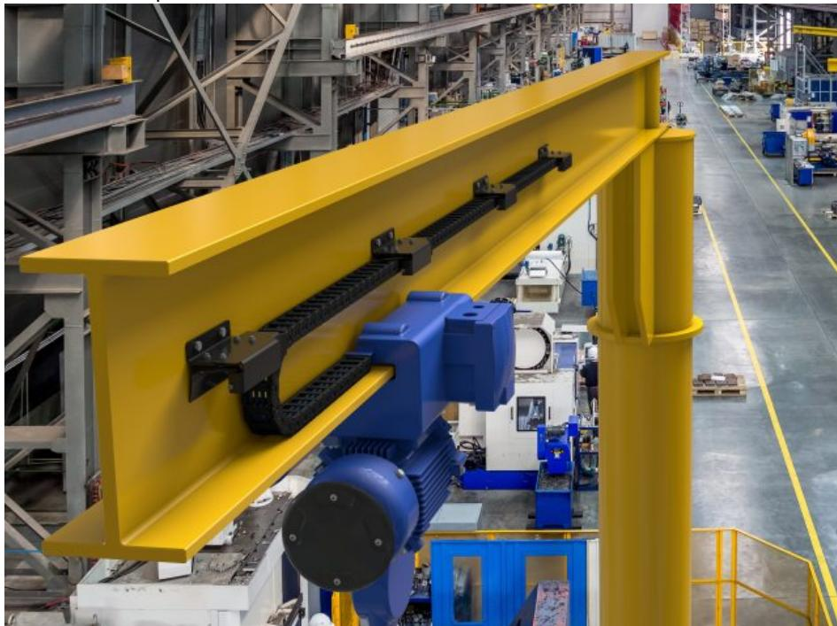
Das neue Energieführungssystem ermöglicht es, die Ausfallsicherheit und Produktivität von Krananlagen zu erhöhen (Bild: igus).
