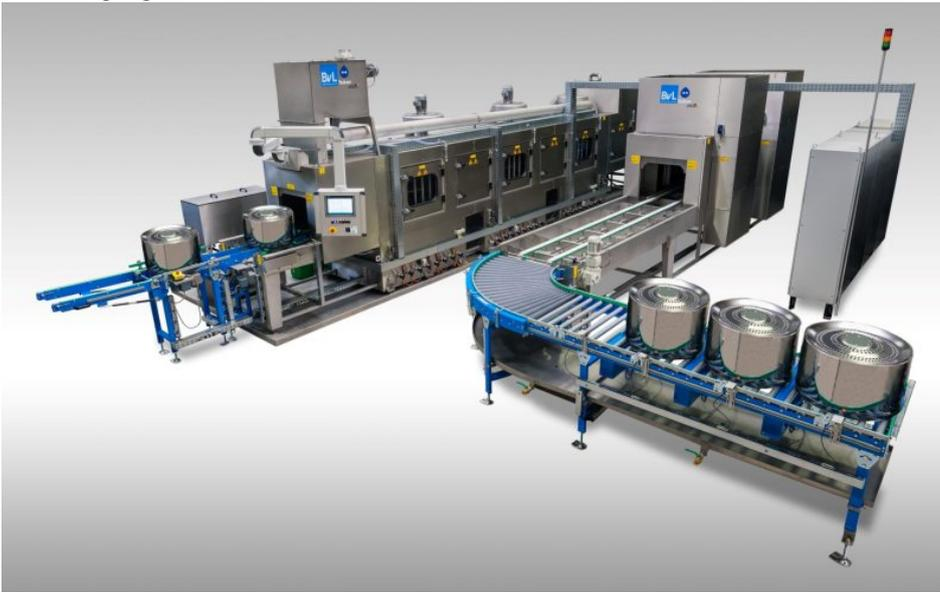
Die Reinigung und Trocknung von Wäschetrockner-Trommeln erfolgt in einer kurzen Taktzeit von nur 12 Sekunden (Bild: BvL).
