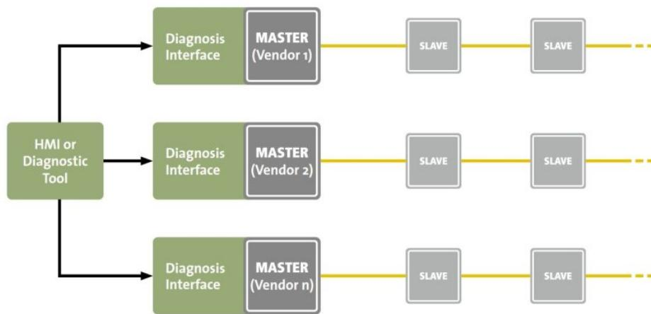
Die Diagnoseschnittstelle ermöglicht einen steuerungsunabhängigen Zugriff auf die Ethercat-Diagnosedaten. Bild ETG
