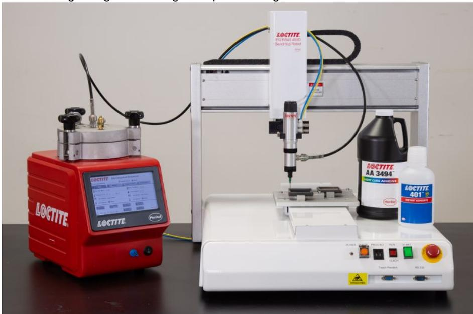
Die Prozesslösungen für Kleb- und Dichtstoffe umfassen auch Equipment wie diesen Dosierroboter (Bild: Henkel).
