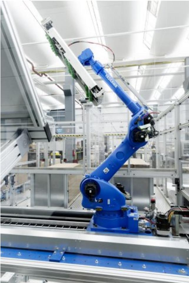
Die größeren Roboter mit aktueller Robotersteuerung können Energie ins Netz zurückzuspeisen (Bild: Yaskawa).
