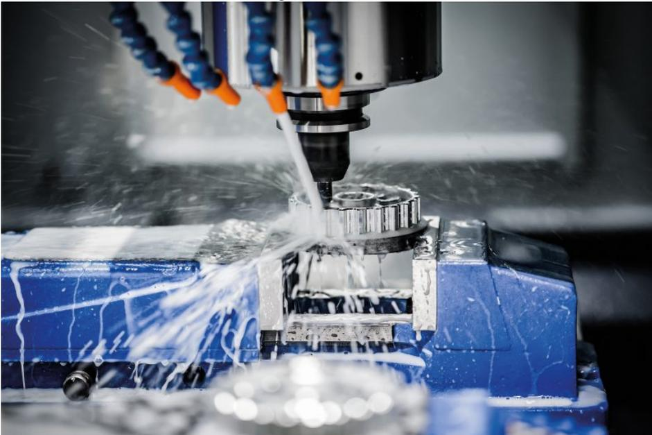
Der wassermischbare Kühlschmierstoff von oelheld verhindert beim Hartmetallschleifen eine Kobaltauswaschung (Bild: shutterstock 383152465).
