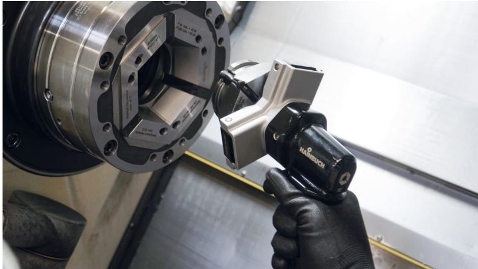
Die neue universelle Wechselvorrichtung zum einfachen und schnellen Wechseln von Spannköpfen (Bild: Hainbuch).
