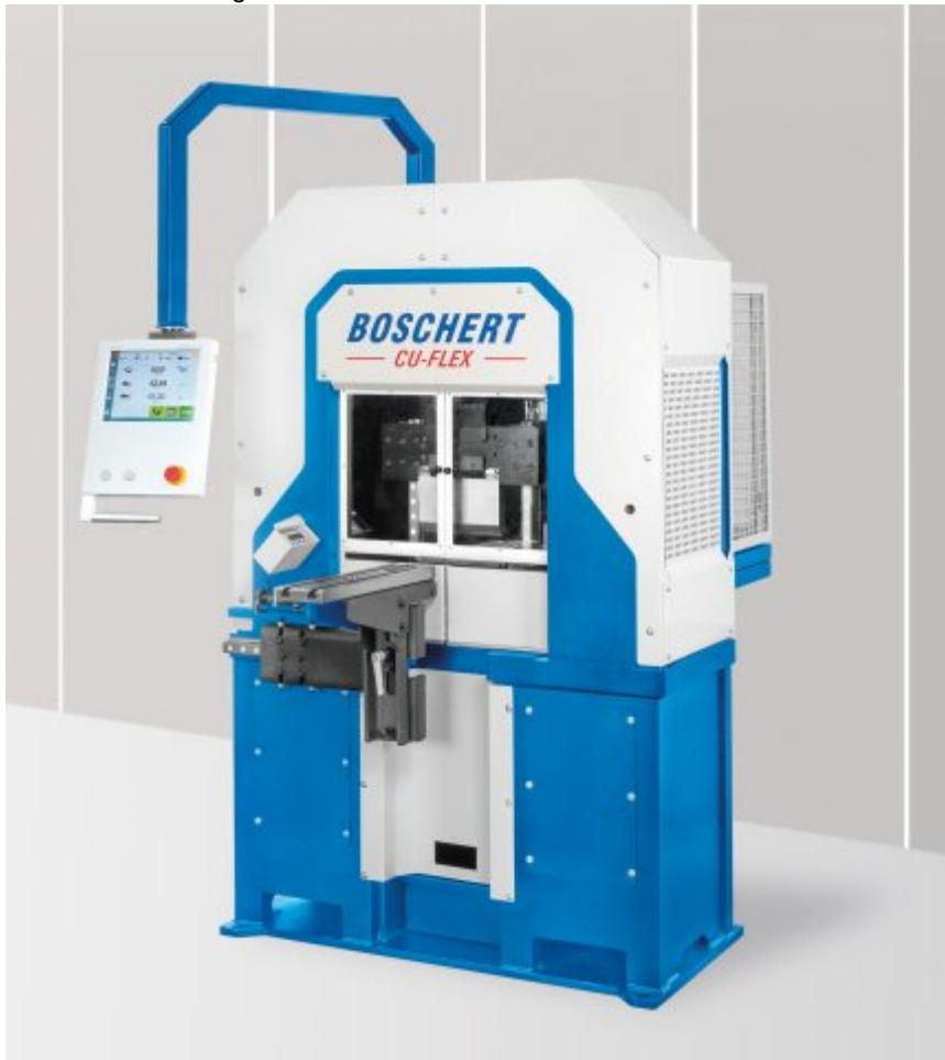
Das Bearbeitungszentrum zum Stanzen, Biegen und Scheren von Kupferwerkstoffen ist jetzt deutlich kompakter (Bild: Boschert).
