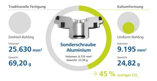
Der Wechsel der Produktionstechnologie führte zu einem geringeren Product Carbon Footprint (Bild: Arnold Umformtechnik).
