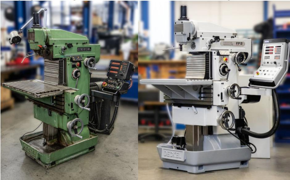
Vergleich einer »alten« Deckel-Maschine mit der komplett überarbeiteten und modernisierten Version (Bild: FPS).
