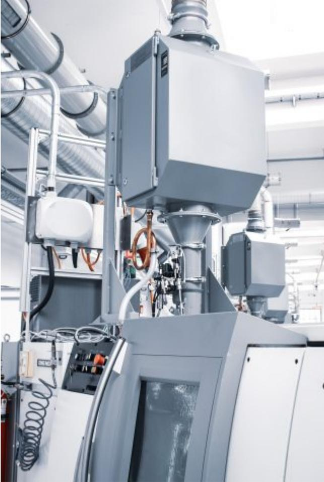
Die Flammensperre von Büchel verhindert zuverlässig, dass sich ein Maschinenbrand über die Absauganlage auf die gesamte Fertigung ausbreitet (Bild: Böllhof).
