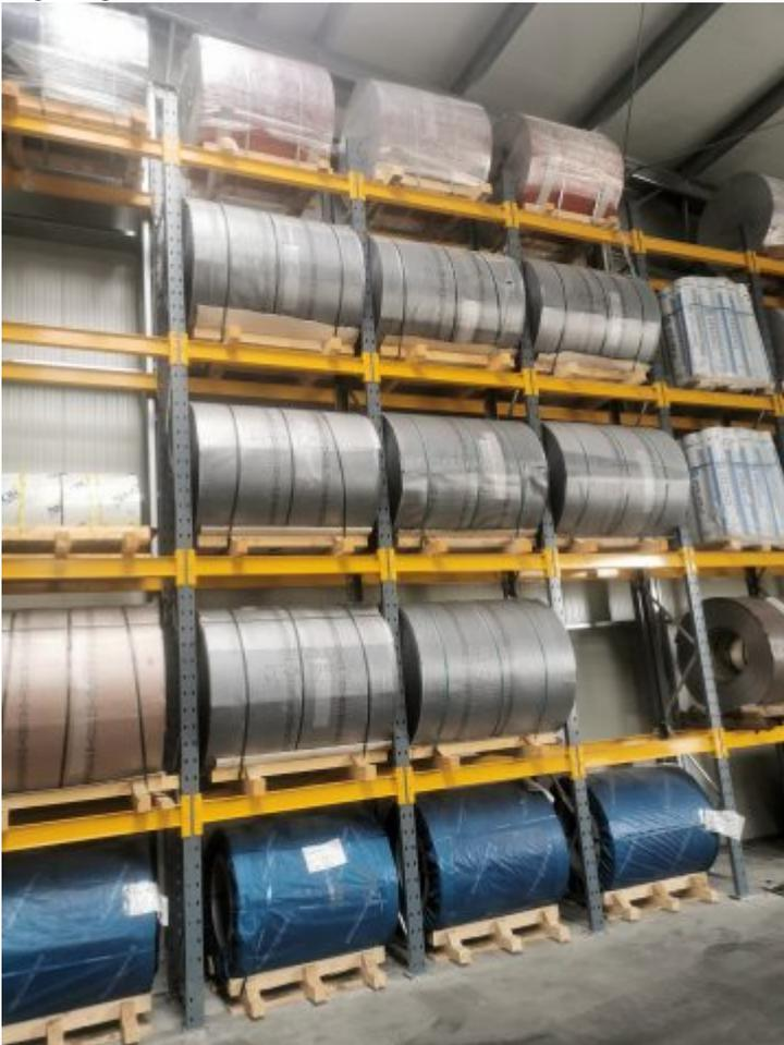
Das 19,9 m lange Schwerlast-Palettenregal bietet auf 6 m Höhe fünf Lagerebenen mit einer Fachlast von jeweils 5 t (Bild: Ohra).
