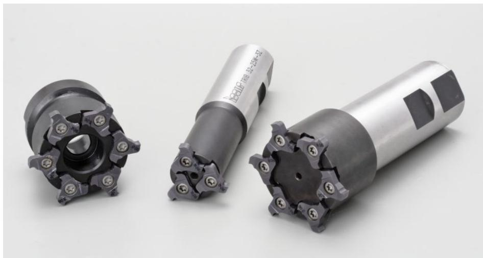
Der Schlitzfräser wurde mit 30 % vergrößerter Auflageflächen für die dreischneidigen Wendeschneidplatten optimiert (Bild: Iscar).
