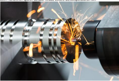
Beim Hartfräsen zeigen die VHM-Schaftfräser mit der speziellen Beschichtung hohe Fräsleistungen (Bild: Horn/Sauermann).
