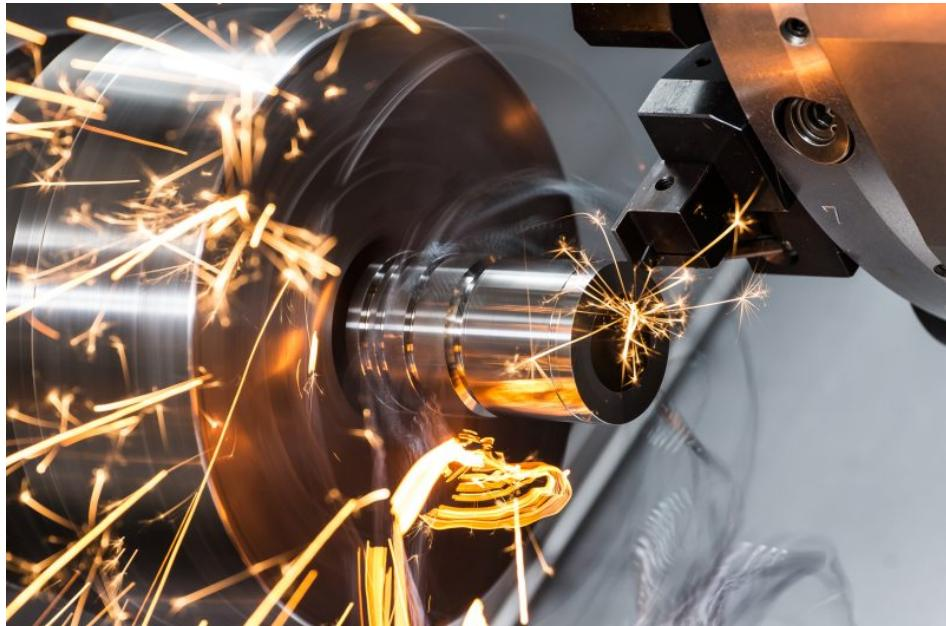
Zum Hartdrehen und -stechen setzt das Tübinger Unternehmen auf den Schneidstoff CBN (Bild: Horn/Sauermann).
