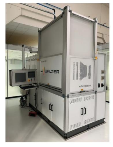
Prüfstand für Minimalmengenschmierung (Bild: Walter).
