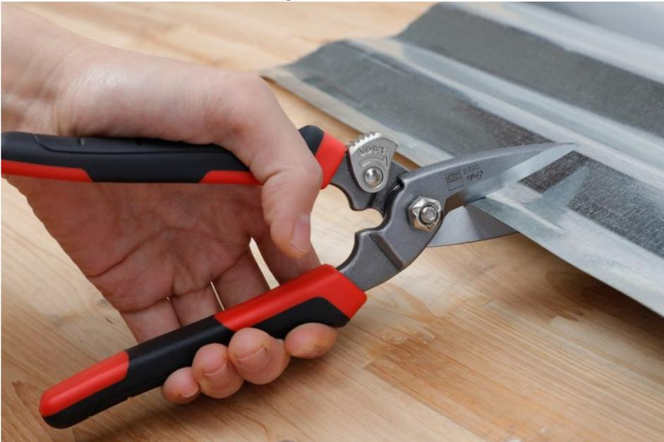
Die universelle Schere schneidet auch 0,6 mm dickes Stahlblech (Bild: Bessey).
