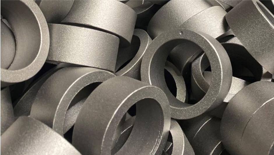
Raustrahlen, die nicht-chemische Alternative zum Phosphatieren, realisiert konstante Rauheitswerte (Bild: KST).
