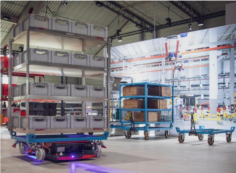
Der autonome mobile Transportroboter bewegt Trolleys und Paletten effizient im Lager (Bild: Linde Material Handling).
