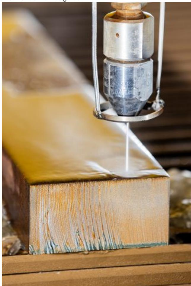
Materialien wie Baustahl lassen sich mit dem Wasser-Abrasiv-Suspensionsstrahlschneiden schnell und präzise trennen (Bild: ANT).
