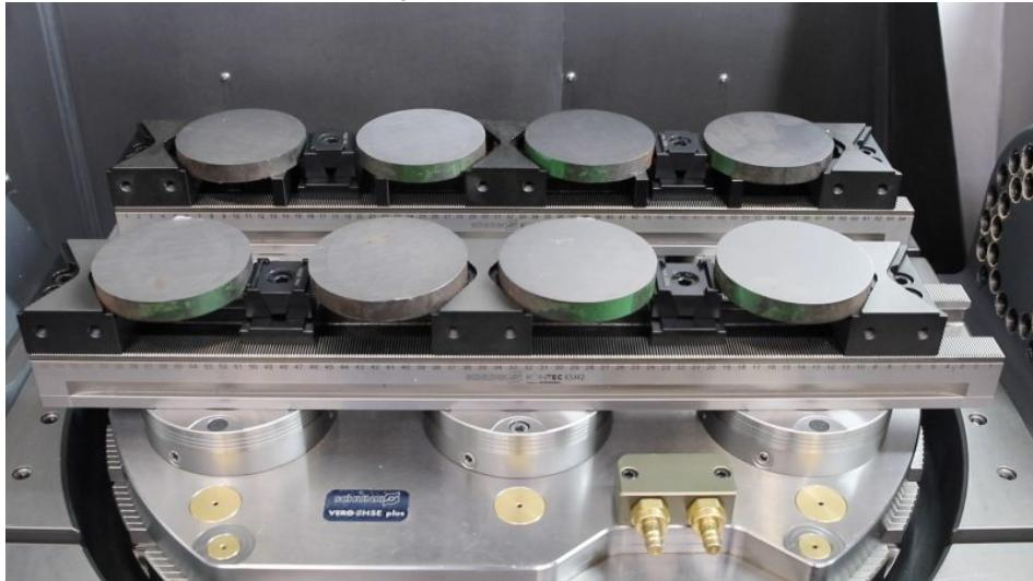
Das Mehrfach-Spannsystem mit einer Keilspannelemente-Spannung (Bild: Gressel).
