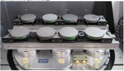
Das Mehrfach-Spannsystem mit einer Keilspannelemente-Spannung (Bild: Gressel).
