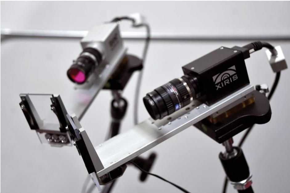
Die Kameras erlauben klare Sicht auf sehr helle Schweißlichtbogen (Bild: Polytec).
