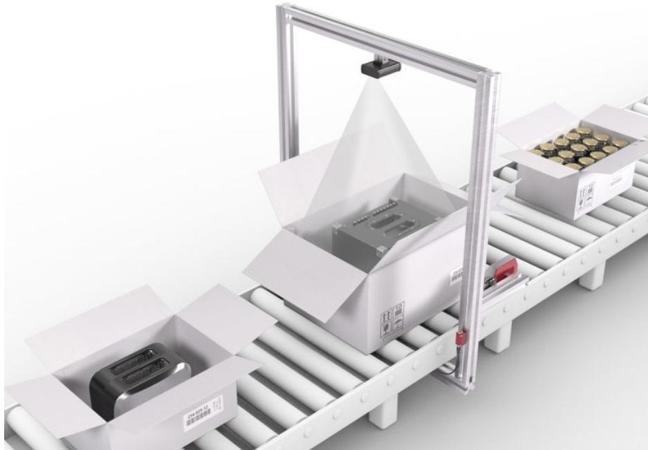
Anwendungsbeispiel: Per Single-Shot-Modus nimmt die Kamera am Ende des Kommissionierprozesses ein einzelnes Bild des Kartoninhaltens auf. So ist im Reklamationsfall einfach nachprüfbar, ob die Ware beim Verlassen des Logistikzentrums vollständig war (Bild: Leuze).
