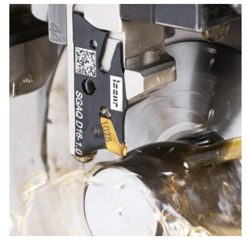
Das modulare Abstech- und Einstechwerkzeug »Neogrip« wurde speziell für Langdrehmaschinen entwickelt (Bild: Iscar).
