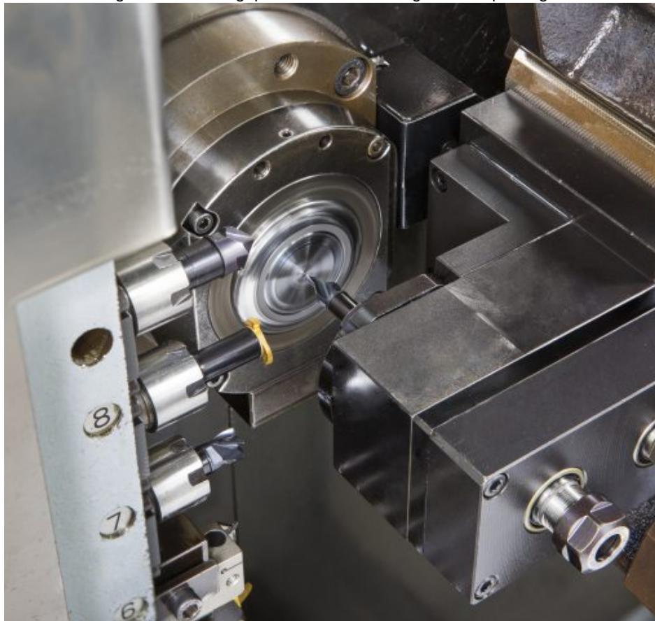
Beim modularen Wechselkopf-Frässystem »Multimaster« entfallen durch das Wechseln der Fräsköpfe in der Maschine unproduktive Nebenzeiten (Bild: Iscar).
