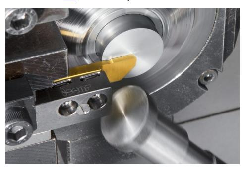
Das Werkzeug mit extralanger Wendeplatten sorgt für eine größere Schnitttiefe beim Ab- und Einstechen sowie beim Stechdrehen (Bild: Iscar).
