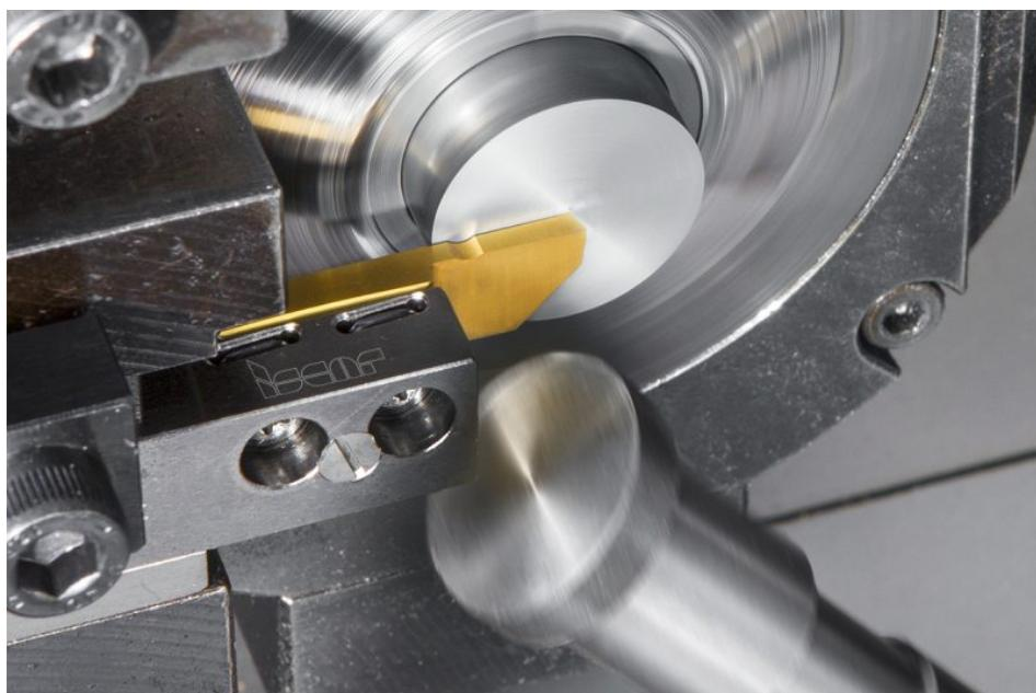
Das Werkzeug mit extralanger Wendeplatten sorgt für eine größere Schnitttiefe beim Ab- und Einstechen sowie beim Stechdrehen (Bild: Iscar).
