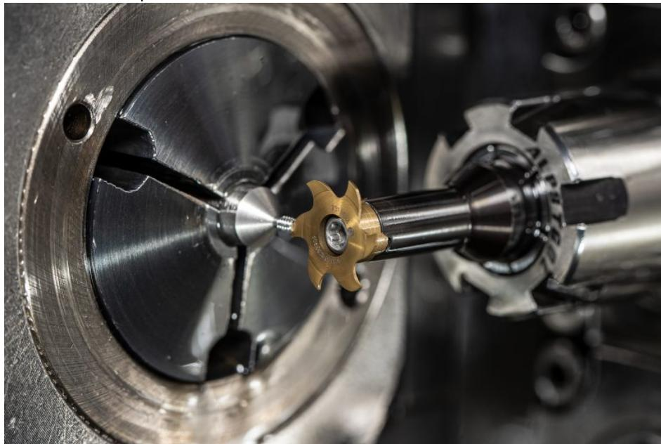
Fräsen eines Schlitzes mit dem Zirkularfrässystem »606« (Bild: Horn/Sauermann).
