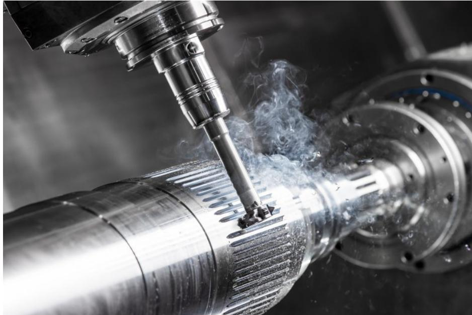
Auch bei langen Auskragungen zeigt das Horn-Frässystem seine Stärken (Bild: Horn/Sauermann).
