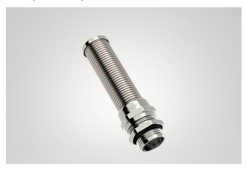
Die Kabelverschraubung aus Messing wurde für die EMV-gerechte Einführung von kupfergeschirmten Kabeln entwickelt und ist mit einer Biegeschutzspirale aus Edelstahl ausgestattet (Bild: Lapp).
