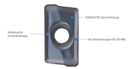
Verschleißfestigkeit, Schlagfestigkeit und Temperaturoxidationsbeständigkeit werden durch das Ultra-Feinkornmatrix-Substrat mit hohem Kobaltgehalt erzielt (Bild: ZCC Cutting Tools).
