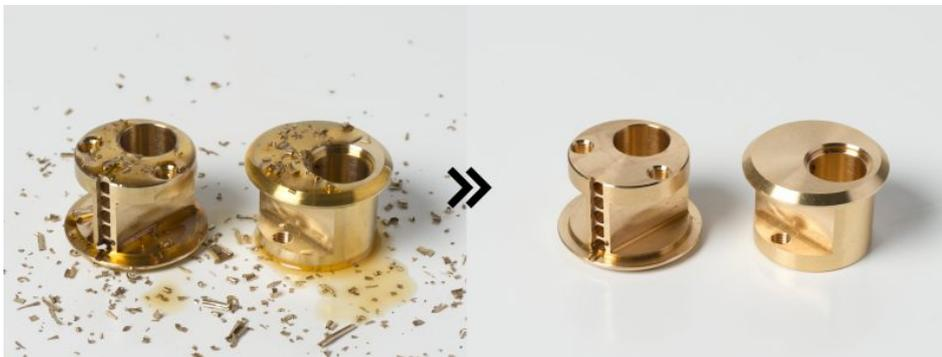
Bauteile werden effektiv von Öl, Kühlmitteln und Spänen gereinigt (Bild: Pero).
