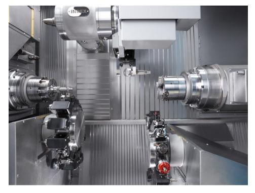
Drehen und Fräsen: Arbeitsraum der »Index G220« (Bild: Index).
