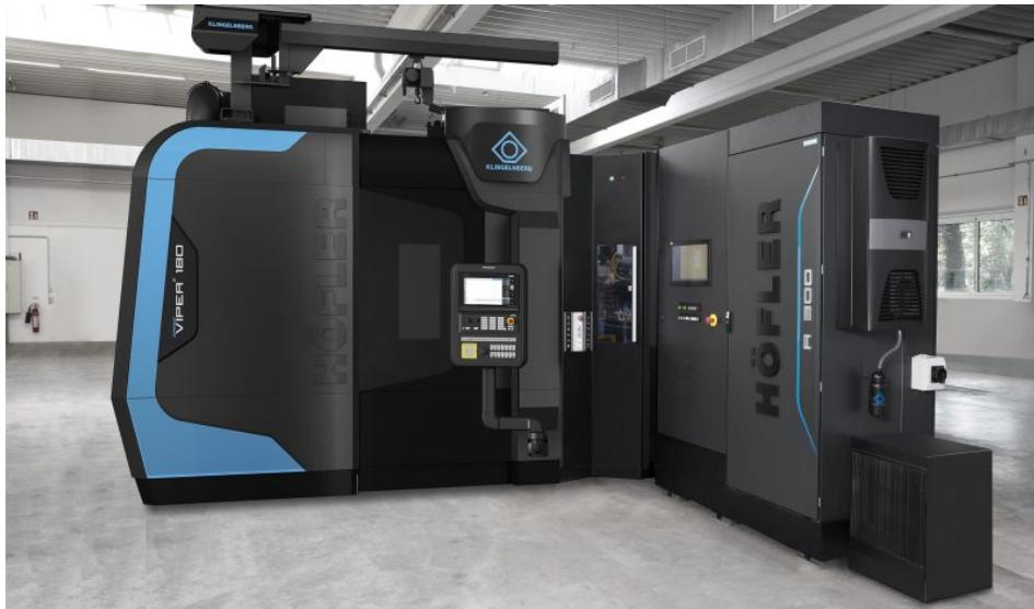
Produktionszelle bestehend aus Stirnrad-Wälzsleifmaschine, Automation und Stirnrad-Wälzprüfmaschine (Bild: Klingelnberg).
