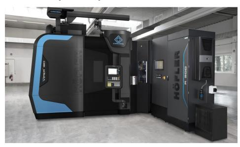
Produktionszelle bestehend aus Stirnrad-Wälzschleifmaschine, Automation und Stirnrad-Wälzprüfmaschine (Bild: Klingelnberg).
