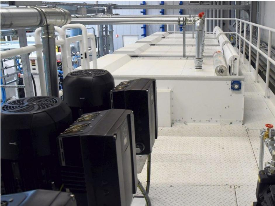
Für die KSS-Filtrierung auf Basis der Kompaktfiltertechnologie wurden in Sonderfertigung ein großer Tank sowie vier Kompaktfiltermodule entwickelt. Gefiltert werden von der Anlage 5000 Liter Emulsion pro Minute (Bild: Lehmann-UMT).
