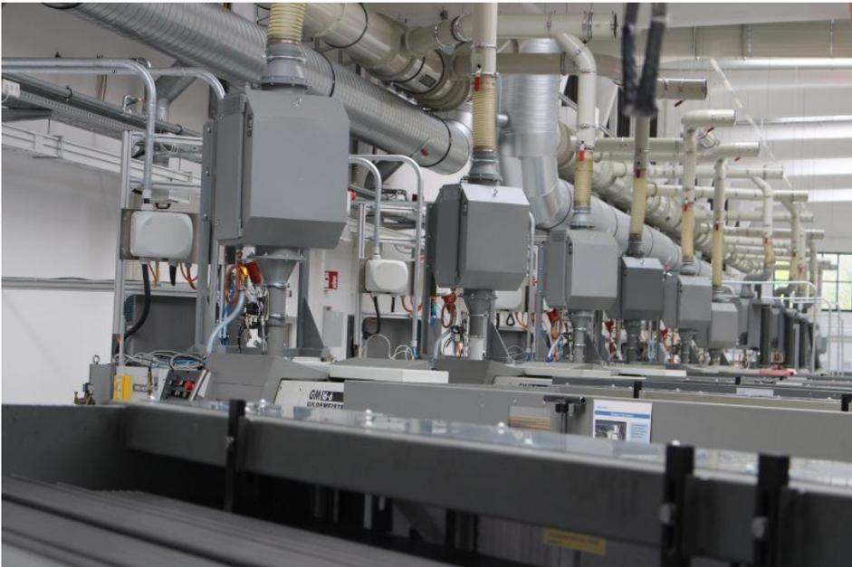
Am Standort in Bielefeld wurden sämtliche Maschinen mit der Flammensperre ausgestattet. Diese wird zwischen Werkzeugmaschine und Absaugleitung geschaltet und kommt ohne Elektronik oder Sensorik aus (Bild: Böllhoff).
