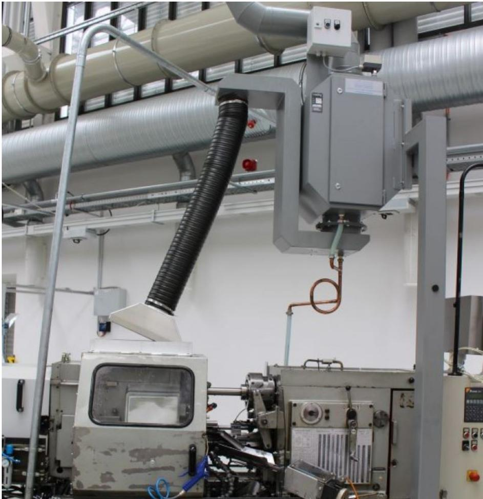
Zusätzlich installierte Büchel seine selbst entwickelten Kipphauben an einigen Maschinen (das Bild zeigt den geöffneten Zustand). Dadurch werden überlange Schläuche vermieden, in denen sich Kühlschmiermittel sammeln kann (Bild: Böllhoff).
