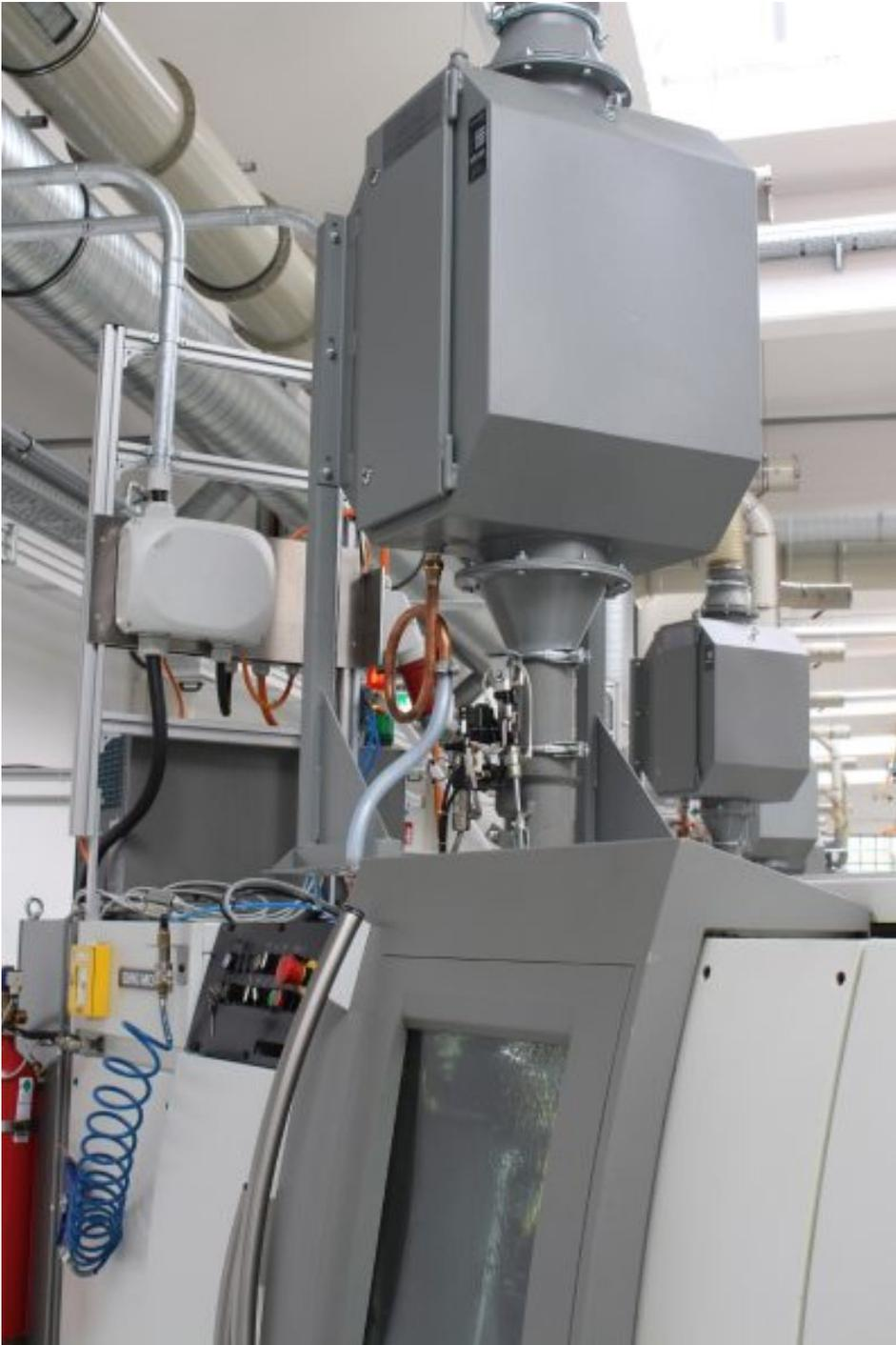
Die Flammensperre kann an jeder Maschine installiert werden und schützt dort effektiv vor Bränden und Verpuffungen (Bild: Böllhoff).
