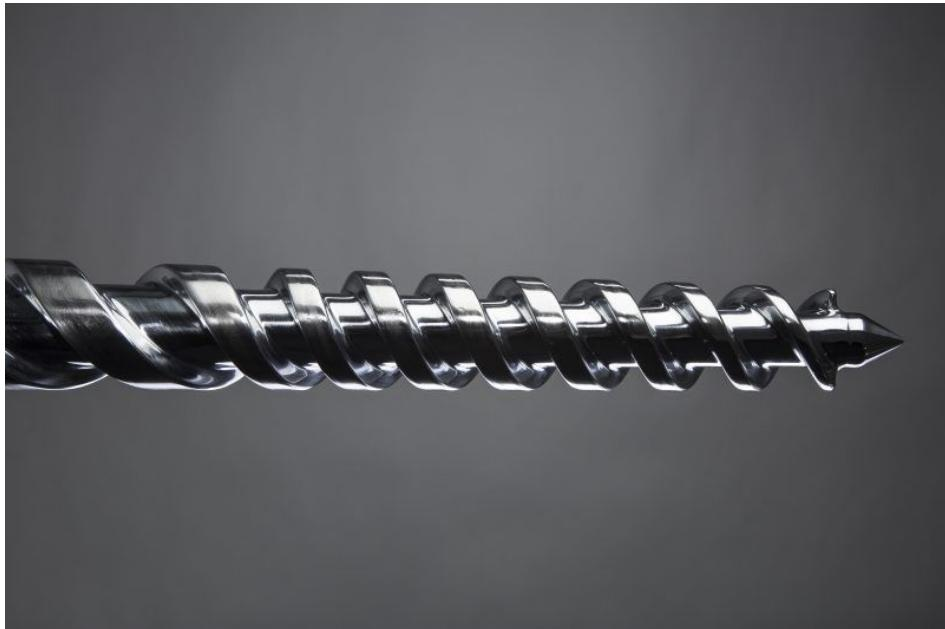
Auch Bauteile mit komplexen Geometrien wie Extruderschnecken können mit der Reparaturhartverchromung regeneriert werden (Bild: Betz-Chrom).
