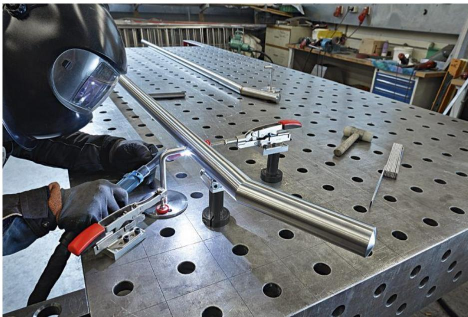
Der Schnellspanner-Adapter »TWA-STC« eignet sich zum direkten Einsatz in die Lochung des Schweißtisches (Bild: Bessey).
