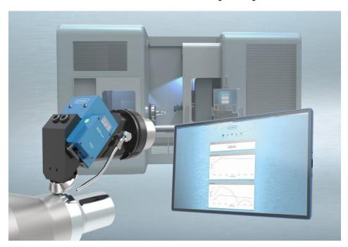
Für die mechanischen Glatt - und Festwalzwerkzeuge wurde eine Lösung entwickelt, mit der die Walzkraft über eine adaptierte Sensorik gemessen und dokumentiert werden kann. Diese Technologie lässt sich jetzt auch in die Maschinenumgebung integrieren (Bild: Ecoroll).
