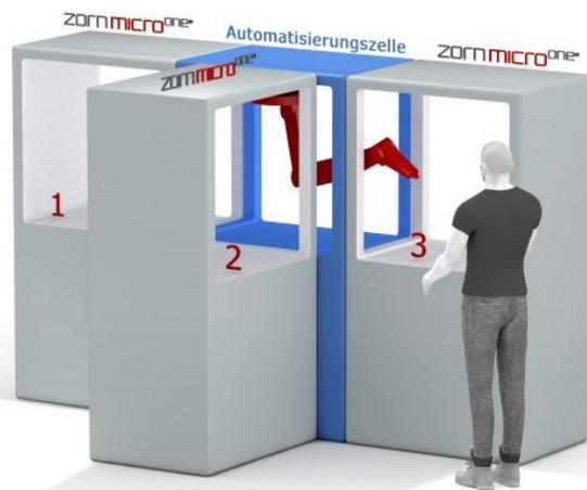
Einer für drei: Ein Bedienroboter ermöglicht den automatisierten Zugriff auf mehrere Bearbeitungszentren (Bild: Zorn).
