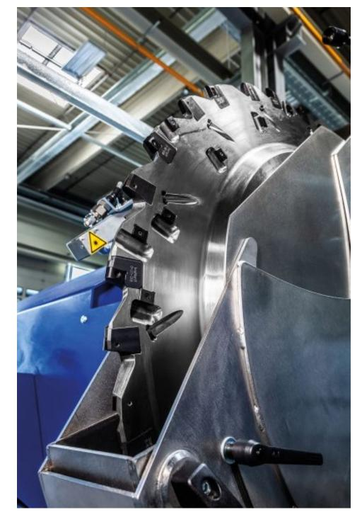
Die Fräswerkzeuge aus Österreich übernehmen auf mobilen und stationären Maschinen die Schweißnahtvorbereitung (Bild: Martin Gold/www.martingold.at).
