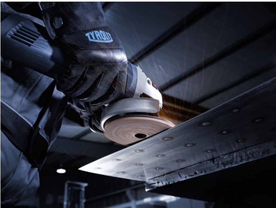
Aufgrund der offenen Struktur eignen sich die neuen Schleifscheiben insbesondere für die Bearbeitung von Nichteisenmetallen wie Aluminium, da sie ein Zuschmieren verhindern und gleichzeitig bestmögliche Oberflächenergebnisse erzielen (Bild: Tyrolit).
