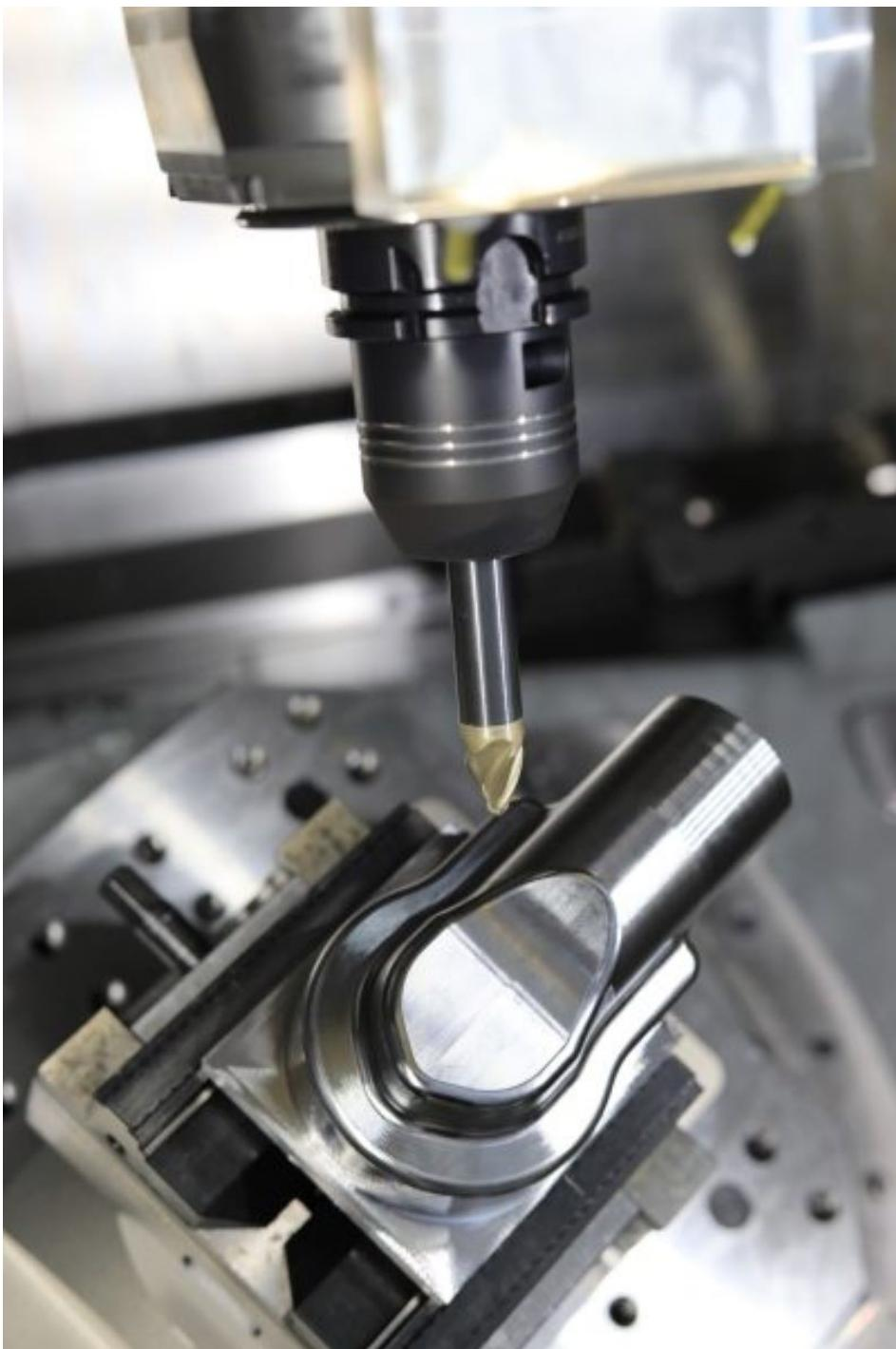
Wirtschaftliche Bearbeitung: Die Kreissegmentgeometrie sowie die Beschichtung ermöglichen das Fräsen mit dynamischen Kontaktpunkten und damit einen deutlich höheren Zahnvorschub (Bild: Walter).
