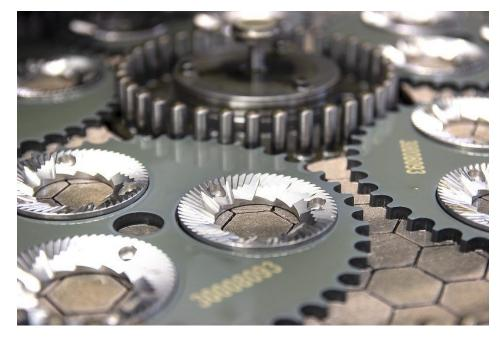
Trotz kompliziertem Werkstück mit großflächiger Unterseite und schmaler oberer Kante kann die Bearbeitung zweiseitig erfolgen (Bild: Supfina).
