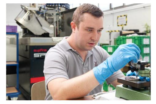
Damit die Mahlscheiben die Kaffeebohnen auch präzise in einem abgestimmten Verhältnis zerkleinern, müssen sie in engen Toleranzen geschliffen werden (Bild: Supfina).
