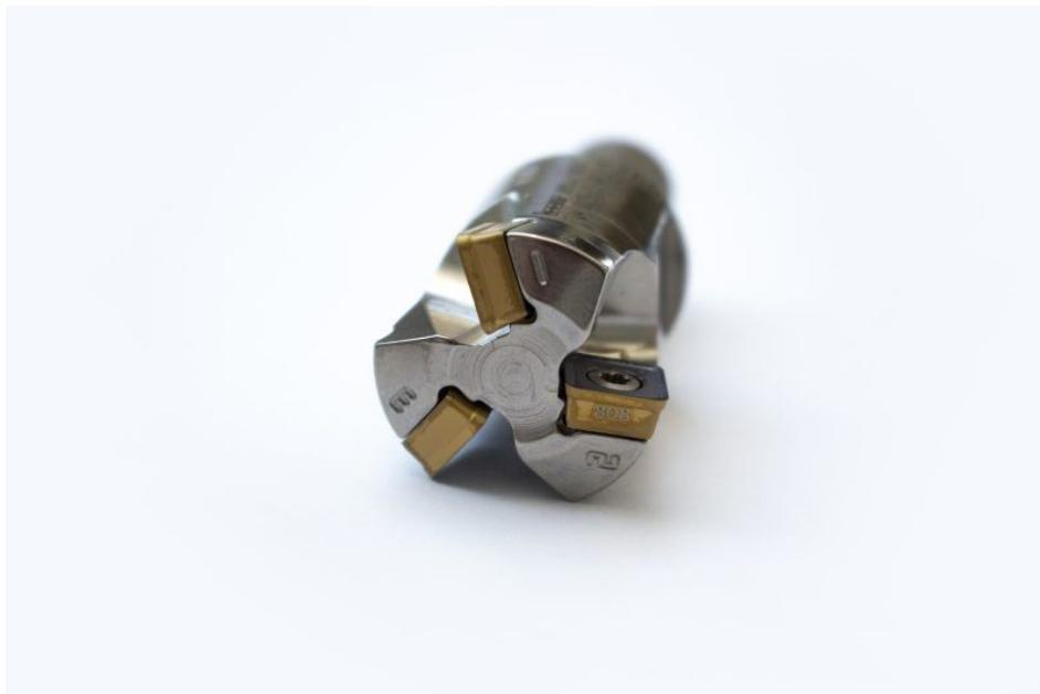
Die eingesetzten RM-HP-Wendeschneidplatten wurden eigentlich für die Bearbeitung von Edelstahl und hochhitzebeständigen Legierungen entwickelt. Ihre Schneidkanten sind nicht so stark verrundet, das sorgt für einen ruhigeren Lauf der Werkzeuge (Bild: Iscar).
